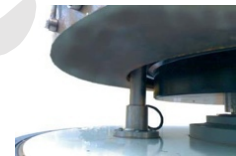
1.4m 直径 - 450g-吨鼓形轨道，带有多重排水口，底部带有虹吸排水通道
