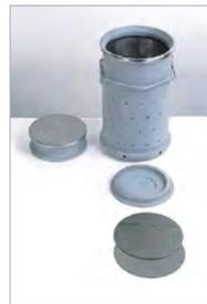
78-PV0250/10 穿孔模具, 直径150mm。用于乳化沥青冷拌压实
